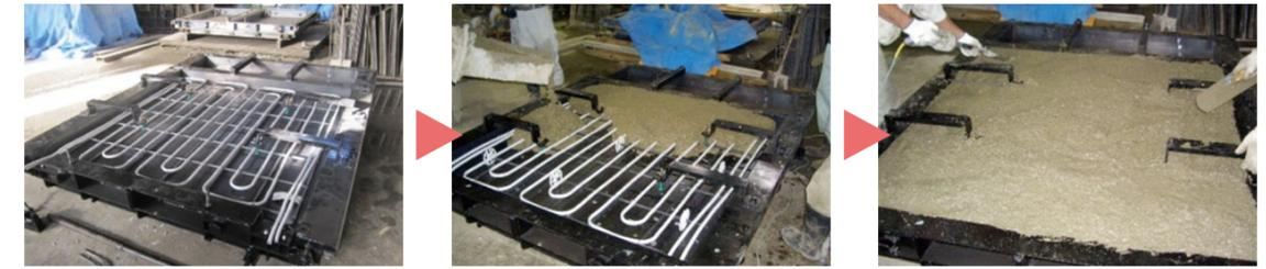
金属強化ポリエチレン管加工組み立て状況
